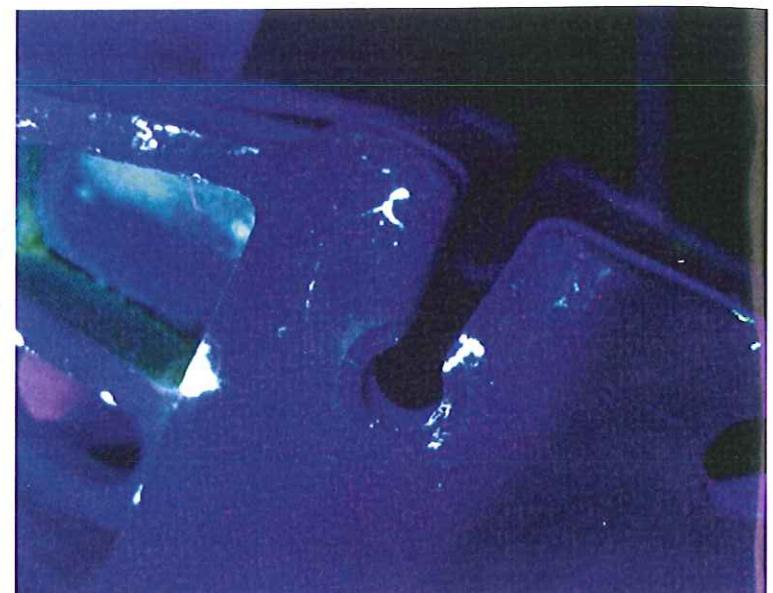
Figure 3: Révélation d'indications à l'aide d'un produit fluorescent
