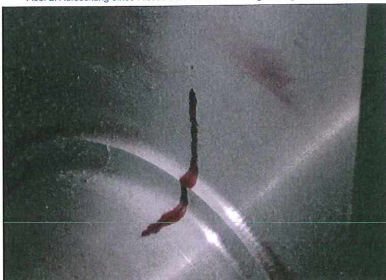
*periode van indringen, dat wil zeggen, de tijd die de vloeistof nodig heeft om in alle spleten te kruipen, zal de overtuigende penetrant (die aan de oppervlakte bleef) geëlimineerd worden. Tenslotte zal een laag van fijn poeder, ontwikkelaar genaamd, op het object toegepast worden om zo de gevangen vloeistof naar het oppervlak van het materiaal te halen, en zo een beeld van hiervan te kunnen geven.*
