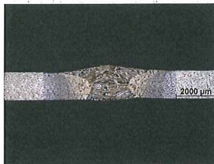
1,6 mm acier DP600, soudé par l'HLW à 4 m par minute avec un écart de 0,6 mm
